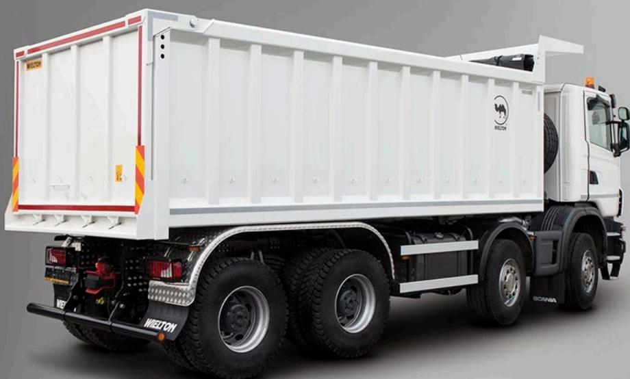
Самосвальные кузова разного объема (от 13 до 32 м<sup>3</sup>) и сечения (квадрат или полукруглый) для перевозки сыпучих грузов, угля и прочих материалов на шасси грузовиков 6x4, 8x4 и 6x6.
