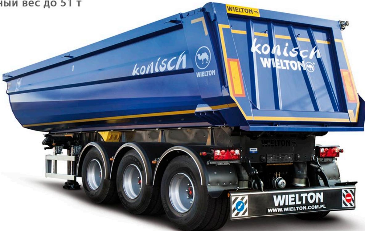
Новая инновационная конусная конструкция кузова значительно улучшает схождение груза, а также позволяет перевозить грузы на паллетах.
